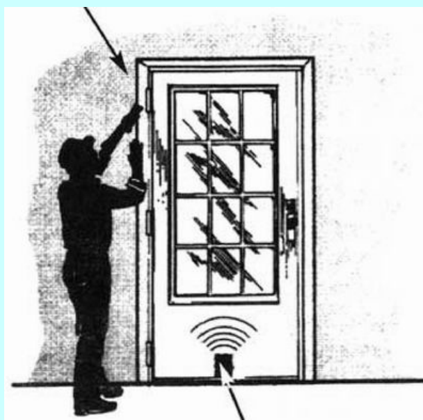
机房门测漏 (TMULD-300)
